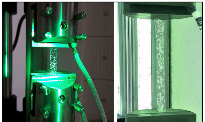
Markierte Glasprobe vor (links) und nach (rechts) dem Hochtemperatur-Zugversuch
