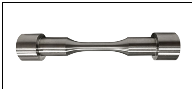
Rundprobe mit Schulterkopf für Zeitstand-Ermüdungsversuch
