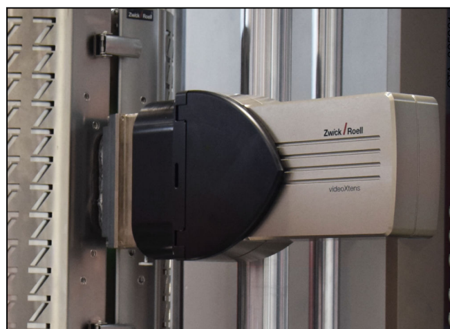
videoXtens 1-32 HP/TZ mit optischem Tunnel an Hochtemperatur-Ofen
